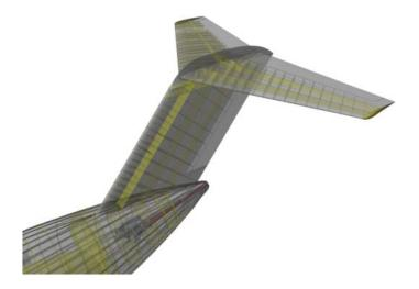
Fig. 66 Empennage Structure
